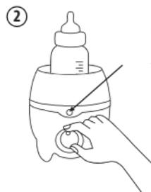
После 4–6 мин. установите терморегулятор в положение «Подогрев до  $t=40^{\circ}\text{C}$ »
