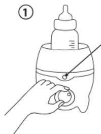
Установите терморегулятор в положение «Подогрев до  $t=100^{\circ}\text{C}$ », загорится красный световой индикатор
