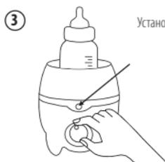
Установите терморегулятор на нужный режим. Световой индикатор загорится красным цветом
