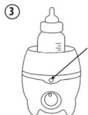
Процесс подогрева будет завершен, когда на панели прибора световой индикатор загорится зеленым цветом
